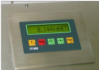
Das Nettofüllgewicht der Flasche wird nun auf dem Display der Waage angezeigt.
