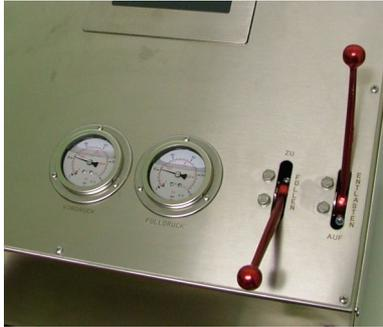
Kugelhahn "Füllen" öffnen, in Stellung "AUF" bewegen, darauf achten, dass  $\text{CO}_2$  in die Füllflasche überströmt, das Ventil also geöffnet ist. Über die Manometeranzeige "Fülldruck" kann dies kontrolliert werden.
