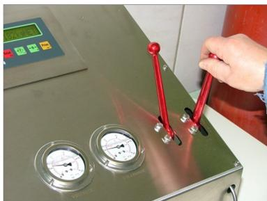
Öffnen Sie nun den Kugelhahn "Entlasten" in Stellung "AUF".
