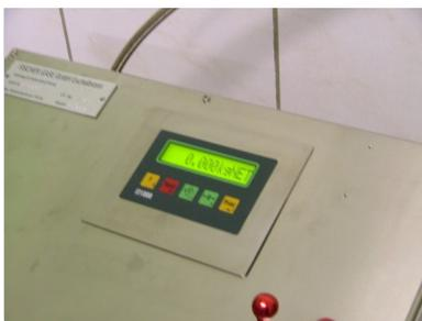
Die Waage schaltet sich ein, zeigt den Gewichtswert des Füllkopfes. Diese Gewichtsanzeige wird durch Betätigung der Tara-Taste auf 00,000 kg gesetzt.
