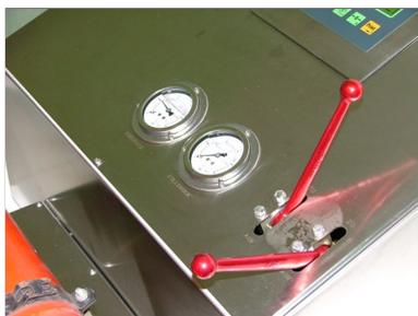
Nach vollständiger Öffnung des Kugelhahnes "Entlasten" zeigt das Manometer Fülldruck auf 0.
