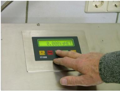
Nach Eingabe des Füllgewichtes oder aber auch bei unverändertem Füllgewicht betätigen Sie die Tara-Taste wenn die Flasche angeschlossen ist.
