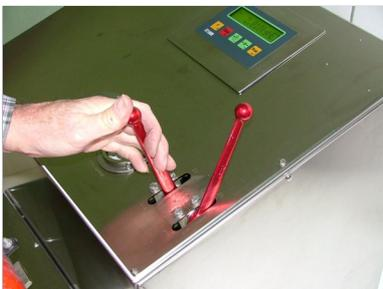
Schießen Sie nun den Kugelhahn "Füllen" in Stellung "ZU"
