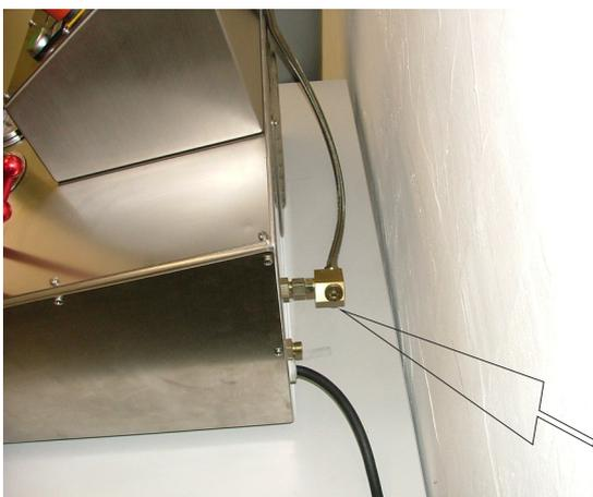
Anschluss des Filterblockes an "EINGANG" an der Rückseite der Füllanlage. An der Verschraubung "Entlastung / Ausgang" schließen Sie nun Ihre Entlastungsleitung an (nahtloses Rohr 10 x 1) damit das zu entlastende CO<sup>2</sup> außerhalb des Füllraumes ins Freie abgegeben wird.
